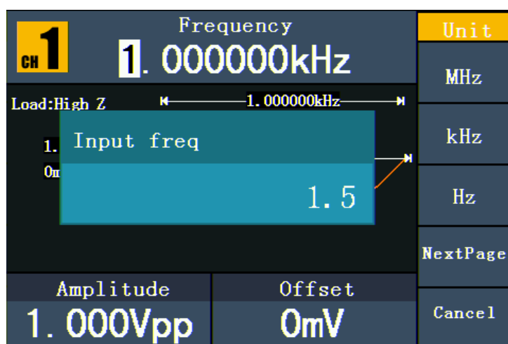
Fig. 0-6 : Réglage de la fréquence à l'aide des touches numériques
