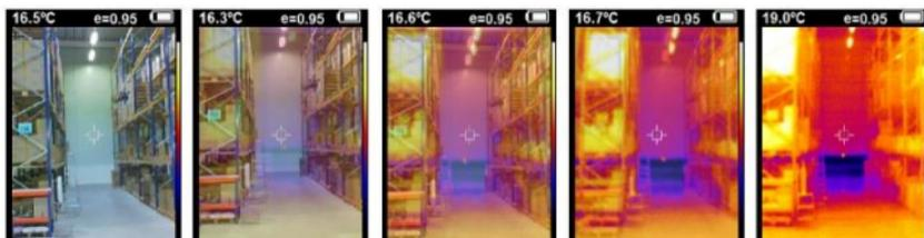
En fonction de la distance de la cible, il peut y avoir un décalage entre l'image IR et l'image de la caméra. Pour contrer ce décalage, appuyez sur Menu, Enregistrement de l'image. Vous pouvez maintenant effectuer un réglage manuel en maintenant l'une des quatre touches fléchées.
