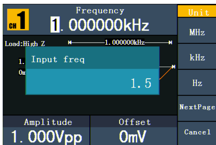
Kuva 0-6: Taajuuden asettaminen numeronäppäimillä.
