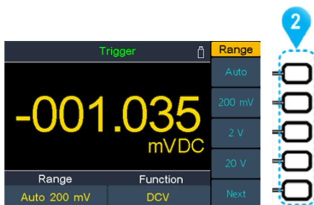
**Sélection automatique de la gamme :** Activez la fonction automatique en appuyant sur la touche supérieure correspondante (2) de la barre de touches logicielles. La sélection automatique de la gamme sélectionne la gamme de mesure en fonction de la valeur d'entrée, mais pas de la fonction de mesure.
