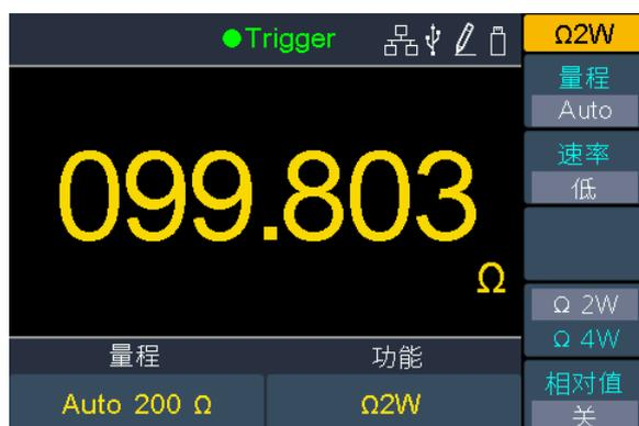
(mesure de la résistance à 2 fils)
