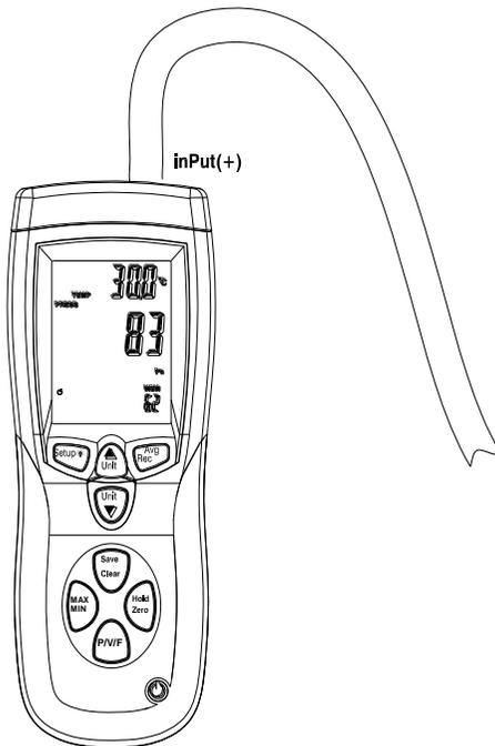
3. Drücken Sie die Taste
