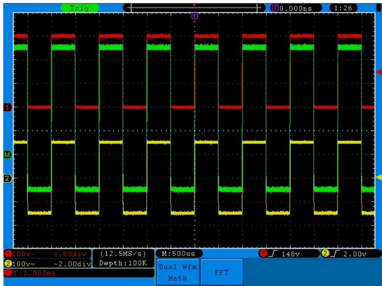
**Fig. 20** Forma de onda resultante del CH1 + CH2
