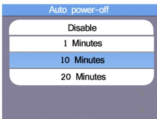
Afin de prolonger la durée de fonctionnement des batteries chargées, l'appareil doit se désactiver automatiquement après quelques minutes (Auto Power Off). Cela permet d'éviter que la batterie ne soit complètement déchargée si l'appareil n'a pas été éteint manuellement par erreur.
