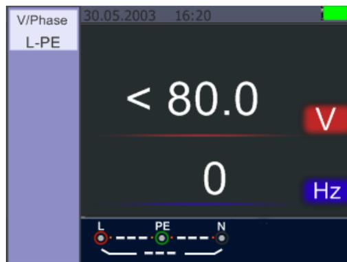
Affichage en veille de la mesure de la tension (< 80V)
