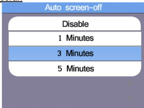
Pour prolonger la durée de fonctionnement des piles chargées, l'écran doit se désactiver automatiquement après quelques minutes (Auto Screen Off), car le rétroéclairage est le plus gros consommateur de l'appareil.
