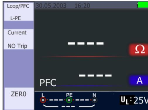
1. Placez le commutateur rotatif sur la position LOOP / PFC.
