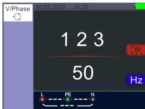
Séquence de phase correcte L1, L2, L3 (champ tournant dans le sens des aiguilles d'une montre)
