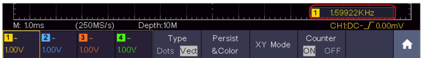
Bild 4.5 Anzeige Frequenzzähler 4CH
