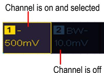
Abbildung 3.8 Anzeige der Kanäle
