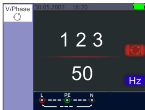
Richtige Phasensequenz L1, L2, L3 (rechtsdrehendes Drehfeld)
