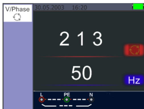
Zwei Phasen vertauscht (linksdrehendes Drehfeld)
